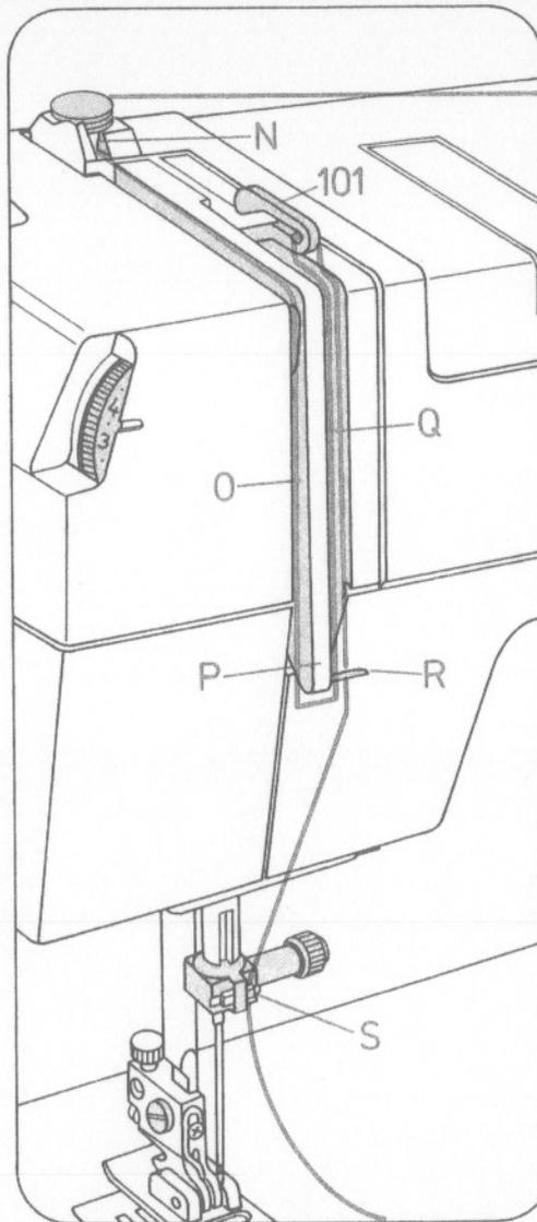
**Oberfaden einlegen:** ● *Hauptschalter 125 ausschalten.* Nadel und Fadenhebel 101 müssen oben stehen. Nähfuß anheben. Den Faden von der Garnrolle in die Spulervorspannung, durch die Öffnung N, den Schlitz O, hinter das Führungsstück P, nach oben in den Schlitz Q, durch den Fadenhebel 101, zurück durch den Schlitz Q, hinter die Führung R und in die rechte Fadenführung S am Nadelhalter ziehen.
