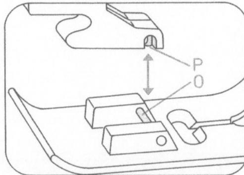
**Nähfuß anbringen:** Stoffdrückerhebel senken und den Fuß dabei so schieben, daß der Steg O in die Nuten P einrastet.
