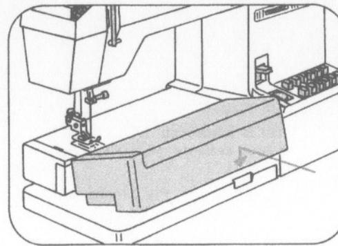
Nähfläche, wie der Pfeil zeigt, an die Maschine schieben.
