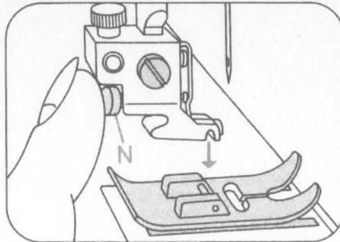
**Nähfuß auswechseln:** ● *Hauptschalter 125 ausschalten.* Roten Knopf N drücken. Der Fuß rastet aus.
