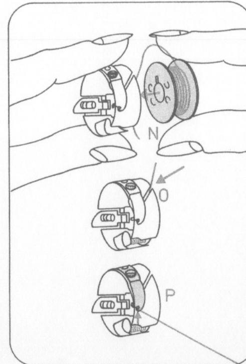
**Spule einlegen N (Faden nach hinten).** Den Faden in den Schlitz O und bis zur Öffnung P ziehen.
