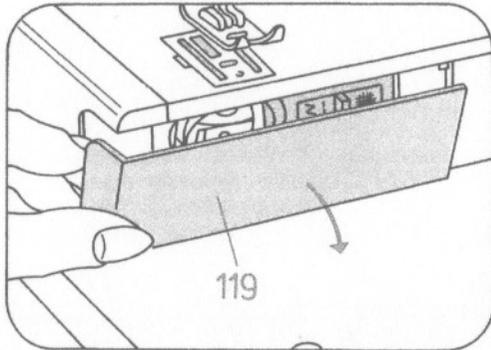
Verschlußklappe 119 öffnen.
