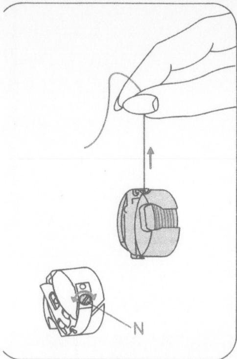
**Unterfadenspannung prüfen:** Kapsel leicht ruckartig aufwärtsbewegen. Sie muß stufenweise niedersinken. (Einstellschraube N nach links drehen = loser, nach rechts drehen = fester).
