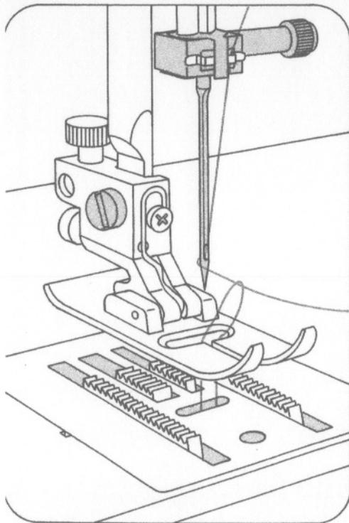
**Unterfaden heraufholen:** Oberfaden festhalten. Handrad nach vorn drehen und einen Stich nähen bis Nadel und Fadenhebel wieder oben stehen. Mit dem Oberfaden den Unterfaden nach oben ziehen.
