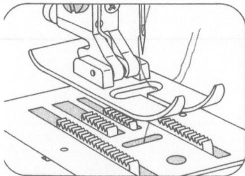
Ober- und Unterfaden nach rechts unter den Nähfuß legen (etwa 10 cm).
