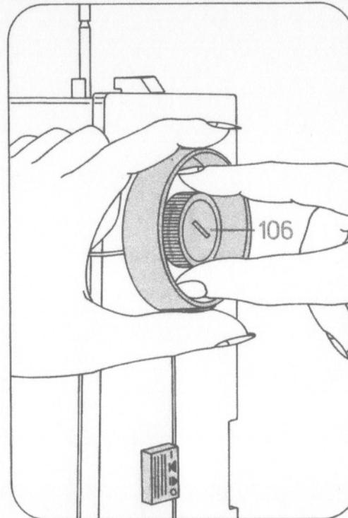
**Nähwerk einschalten:** Handrad festhalten und Scheibe 106 nach hinten drehen. Dann Handrad nach vorne drehen, bis es einrastet.
